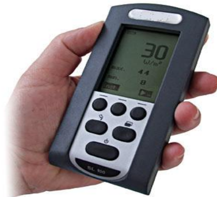
Figura 4 – Medidor de radiação solar portátil
