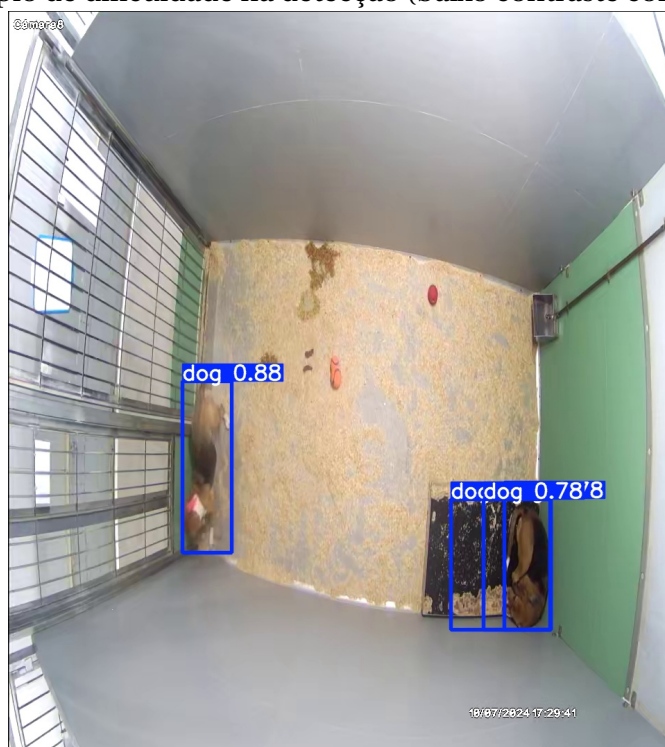
Figura 4.6: Exemplo de dificuldade na detecção (baixo contraste com estrutura preta).
