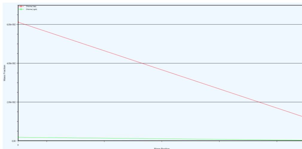
Figura 29 - Perfil de composição de cloro dentro da coluna ao longo do eixo y.
