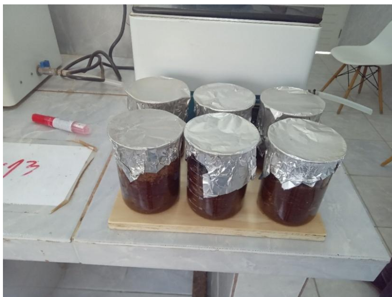
Figura 9: extração aquosa, seis dos doze béckers das amostras. Fonte: autor, 2024.
