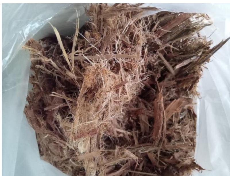
Figura 5: material processado após a primeira moagem, sendo repetido até chegar na granulometria esperada. Fonte: autor, 2024.
