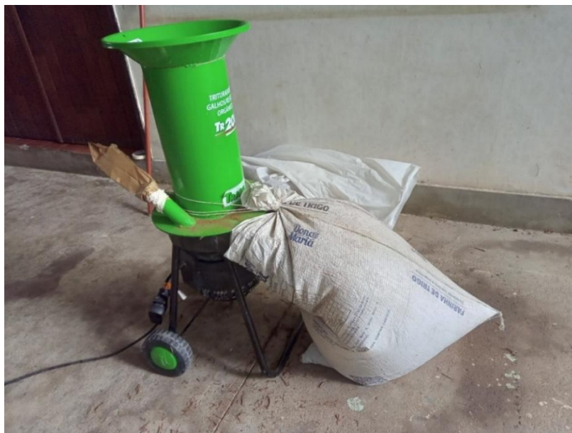
Figura 4: processamento da casca do eucalipto ( Eucalyptus spp.) na primeira trituração. Fonte: autor, 2024.
