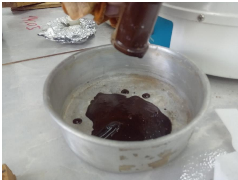
Figura 14: tanino cationizado translocado para as bandejas antes do processo de secagem. Fonte: autor, 2024
