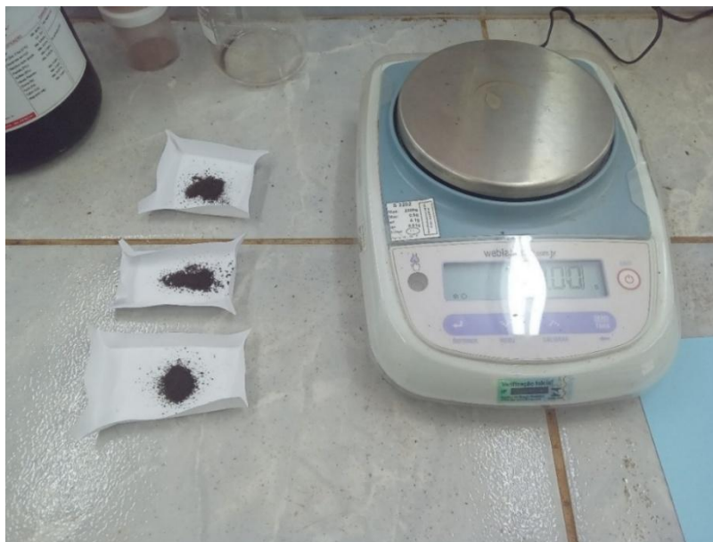
Figura 18: tanino sendo pesado para a aplicação no Jar Test. Fonte: autor, 2024.
