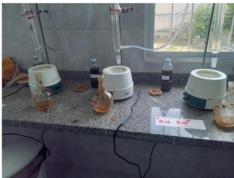
Figura 8: Extrato tânico separado nas três amostras armazenadas em garrafas pet para quantificação do teor de taninos e sólidos totais. Fonte: autor, 2024.
