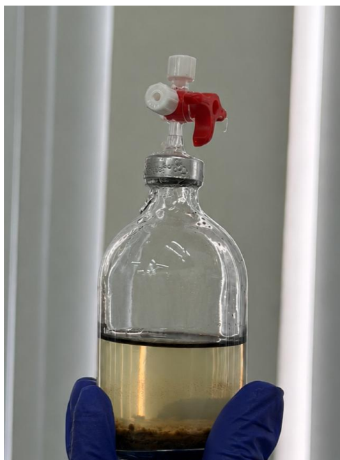
Figura 5. Reator anaeróbio de volume total igual a 120 mL
