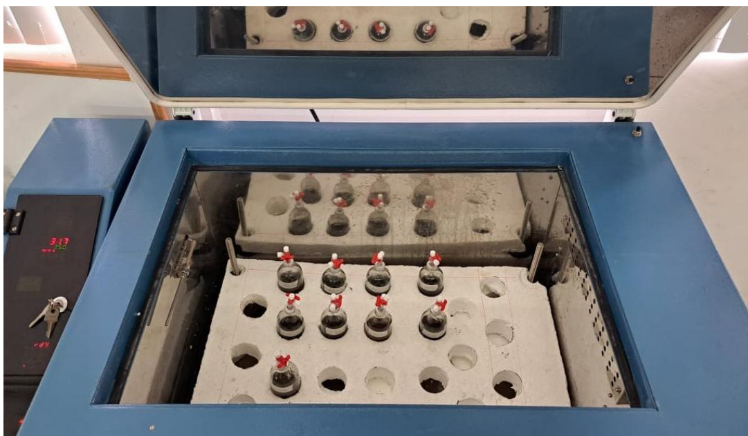
Figura 11. Reatores incubados em câmara agitadora
