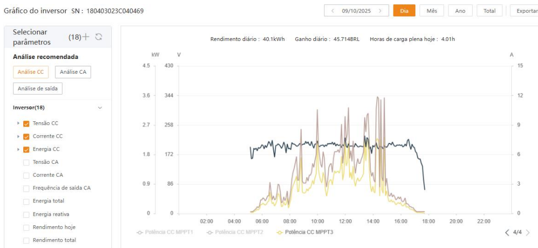
Figura 6 - Monitoramento do sistema via site do fabricante Solis
