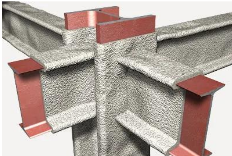
Figura 2.14 – Revestimento em argamassa projetada em estrutura metálica
