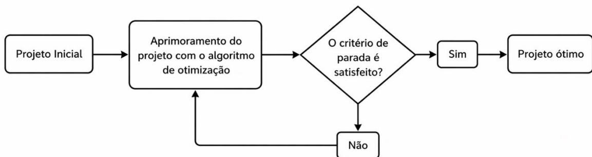
Figura 2.17 – Fluxograma genérico do processo de otimização
