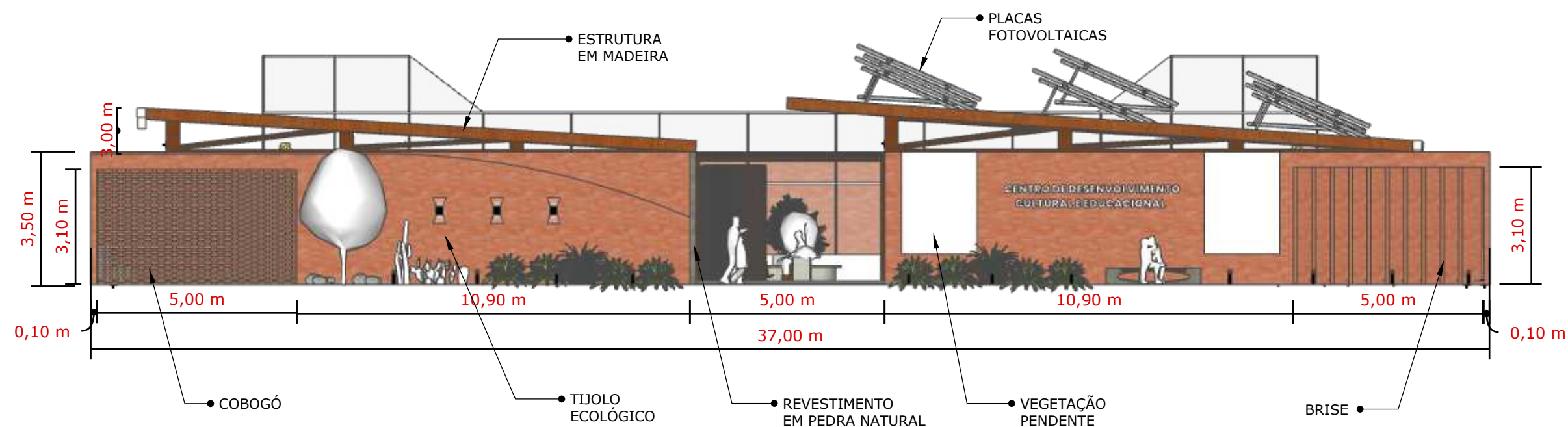
CORTE DE FACHADA FRONTAL ESCALA: 1/200
