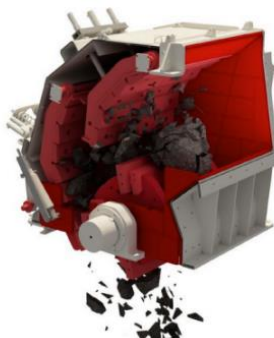
Figura 8 - Corte esquemático do britador de impacto
