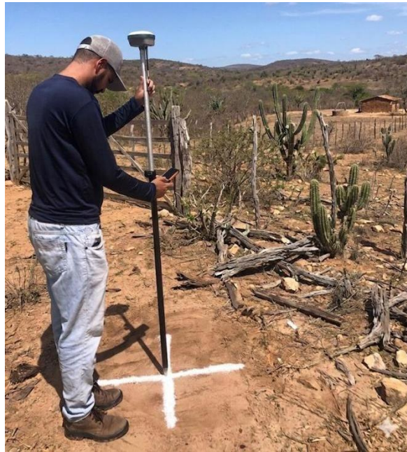
Figura 10: Implantação de Ponto de Controle
