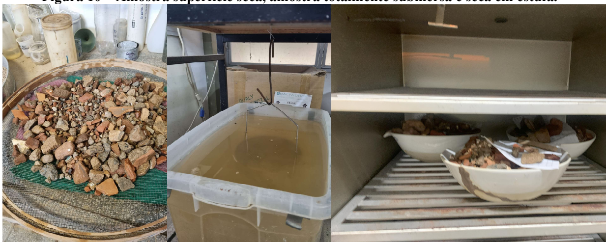
Figura 10 – Amostra superfície seca, amostra totalmente submersa e seca em estufa.
