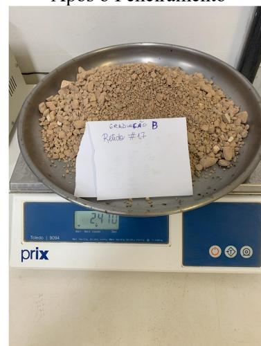
Figura 35 – Material antes do ensaio de abrasão, após o ensaio e o retido na peneira
