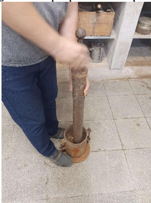
Figura 16 – Corpo e prova sendo compactado
