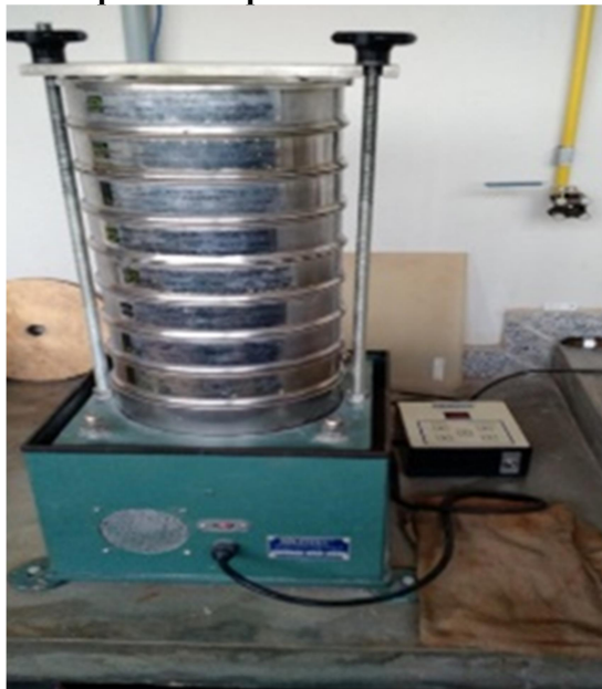
Figura 7 – Agitador e sequência de peneiras utilizadas no ensaio granulométrico
