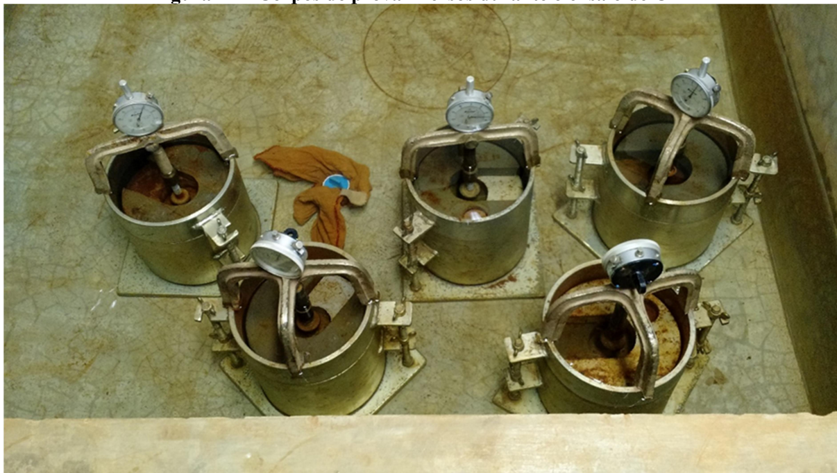
Figura 17 – Corpos de prova imersos durante o ensaio de CBR
