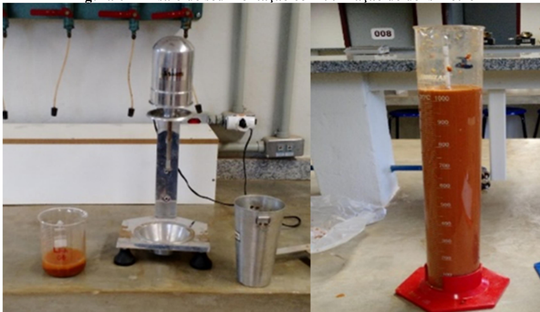
Figura 6 – Ensaio de sedimentação com utilização de densímetro
