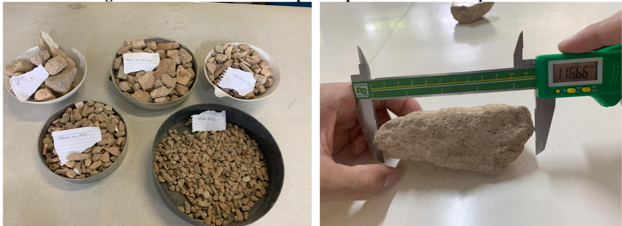
Figura 14 – AR Peneirado e Preparado para o Ensaio do Paquímetro
