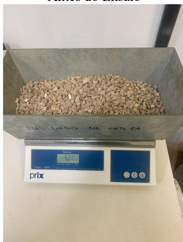
Figura 35 – Material antes do ensaio de abrasão, após o ensaio e o retido na peneira
