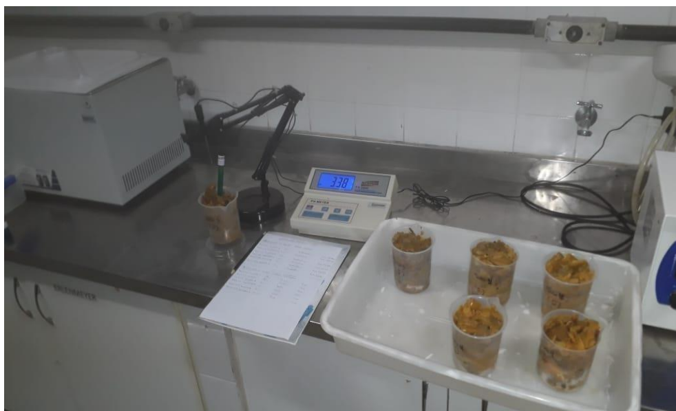
Figura - 7. Coleta de dados referentes à temperatura e pH no processo de estabilidade aeróbica, no laboratório.
