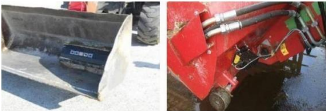
Figura 7. Analisador NIRS acoplado a equipamentos de manejos de alimentos.
