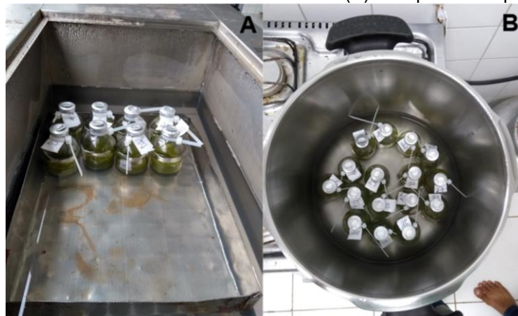
Figura 19. “Micro-rúmen” em banho termostático (A) e na panela de pressão (B)
