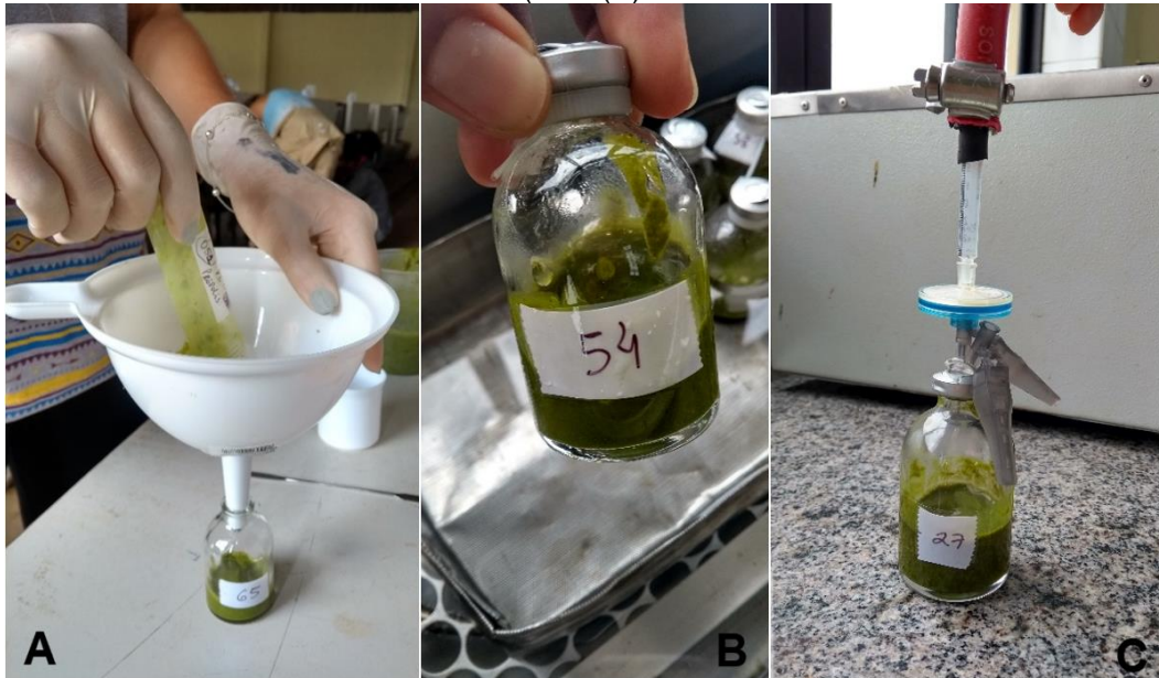
Figura 18. Transferência do líquido ruminal para os frascos de penicilina (A), frascos lacrados com rolhas de borracha e lacre de alumínio (B) e substituição do ar atmosférico por dióxido de carbono (CO 2 ) (C)
