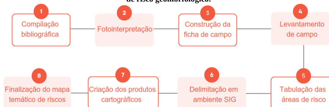
Figura 18 - Sequência de procedimentos desenvolvidos durante a elaboração das setorizações de áreas de risco geomorfológico.
