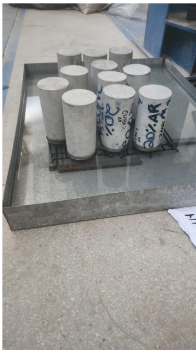
Figura 23 – Ensaio de absorção de água por capilaridade
