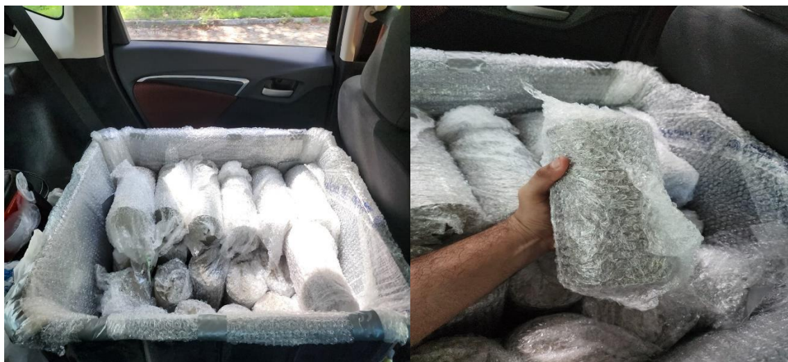
Figura 20 – Recipiente adaptado em plástico bolha (esquerda); concreto protegido por plástico bolha (direita)
