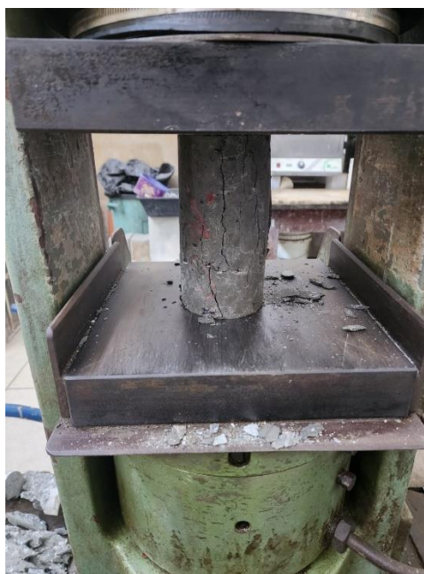
Figura 22 – Ensaio de resistência à compressão
