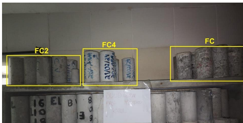
Figura 18 – Concreto curados ao ar (FC, FC2 e FC4)
