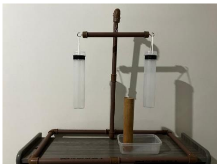
Figura 6.8: Foto mostrando os dois recipientes cilíndricos de PET colocados na estrutura.
