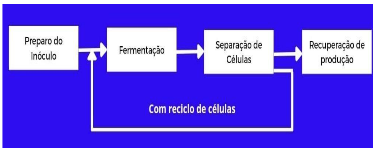
Figura 10: Processo de um biodigestor em operação batelada.
