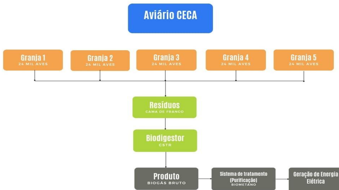
Figura 20: Esquema das granjas e produção de biogás, biometano e geração de energia elétrica.
