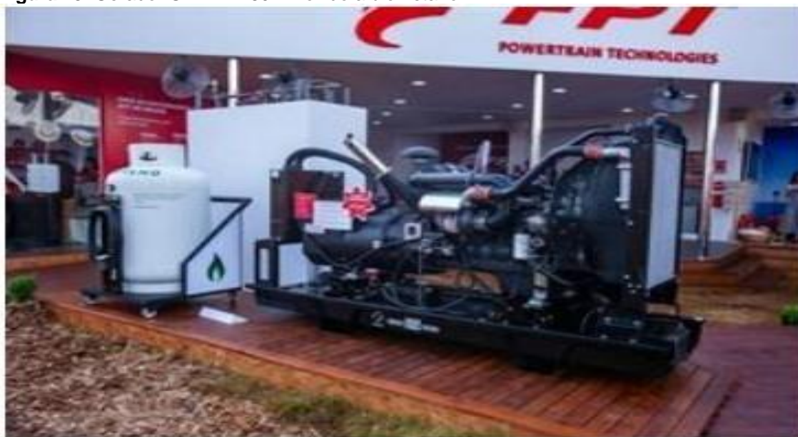
Figura 18: Gerador GENE F 160B movido a biometano.
