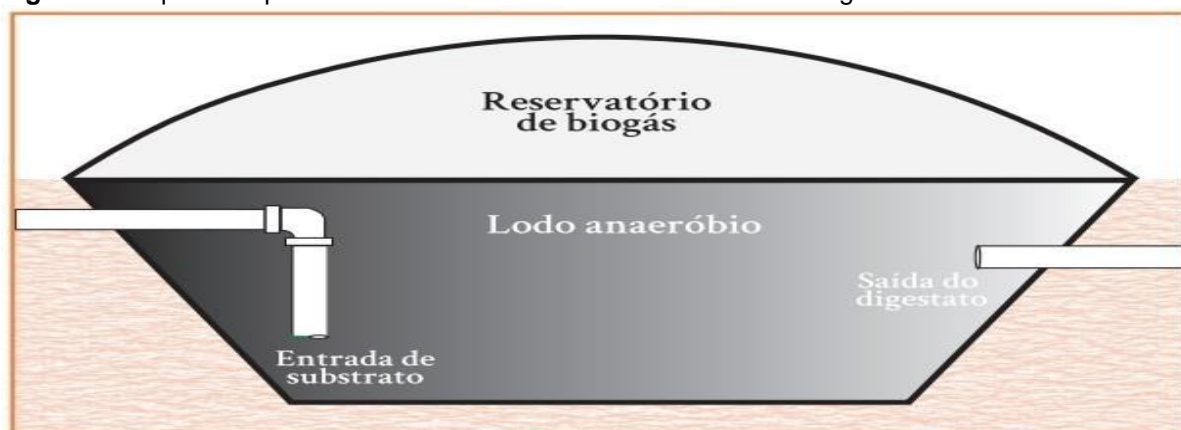
Figura 7: Esquema representativo da visão interna do reator modelo lagoa coberta.
