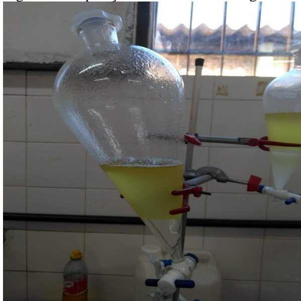
Figura 11 - separação do biodiesel com a glicerina
