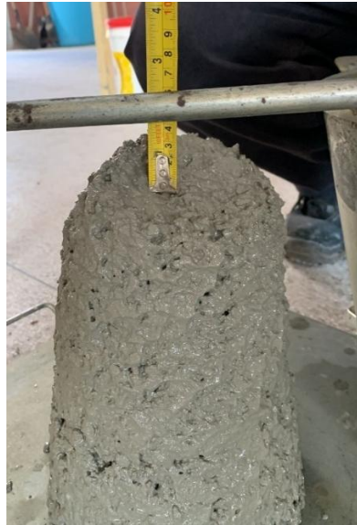
Imagem 11 – Ensaio de abatimento do concreto com 5% de finos Fonte: O autor(2025)
