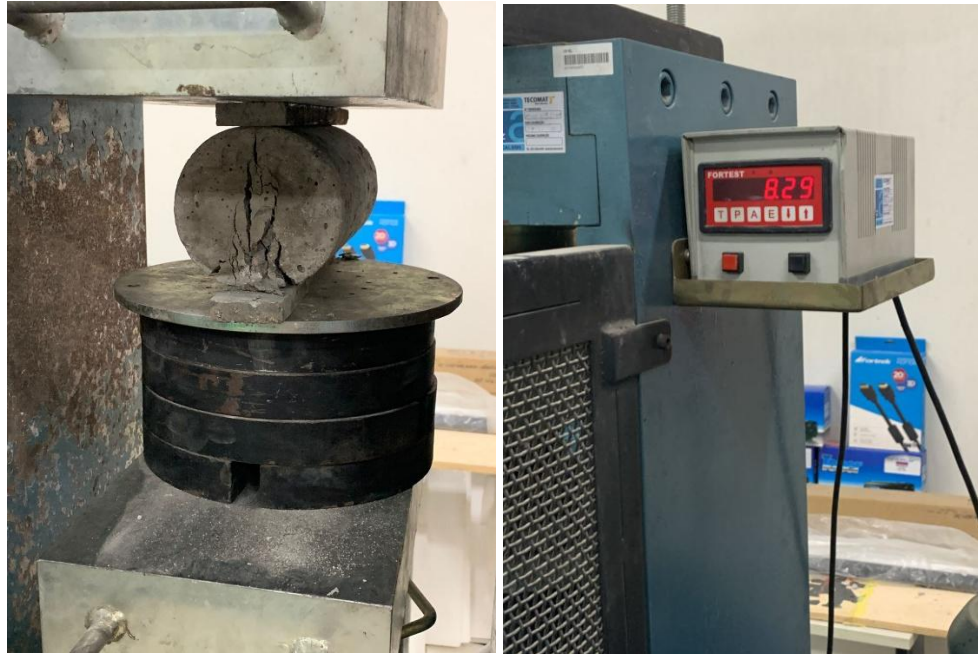
Imagens 8a) e 8b) – 8a) Ensaio de tração por compressão diametral e 8b) Resultado em Newtons
