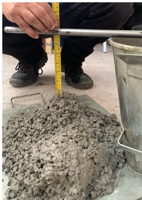
Imagem 12 – Ensaio de abatimento do concreto com 15% de finos Fonte: O autor(2025)
