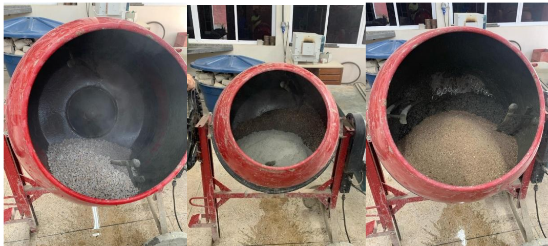
Imagens 3 – a) Inserção de agregado graúdo na betoneira para o traço do Concreto de Referência; b) Inserção de cimento na mistura; c) Inserção de areia na mistura da betoneira.
