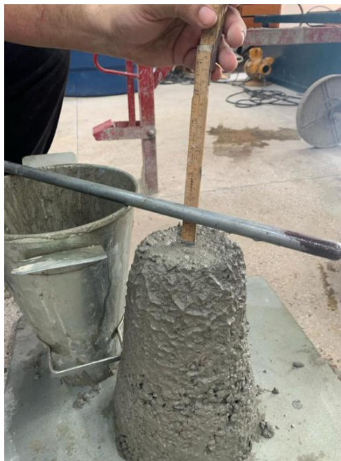
Imagem 10 – Ensaio de abatimento do concreto sem resíduo
