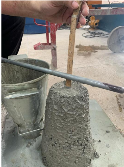
Imagem 4 – Ensaio do abatimento do tronco de cone ( Slump test ) Fonte: O autor(2025)
