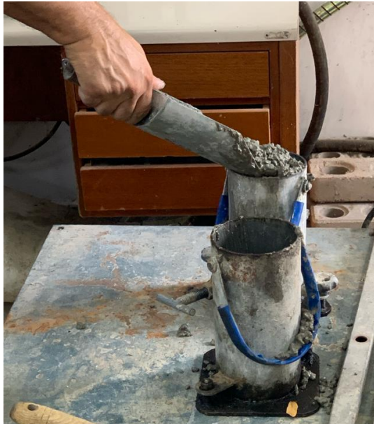
Imagem 5 – Moldagem dos corpos de prova
