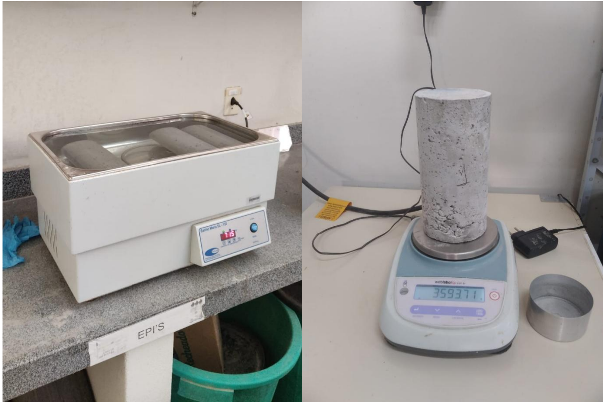
Imagens 9a) e 9b) – 9a) Ensaio de absorção, corpos de prova na água em ebulição por 5 horas e 9b) Pesagem do corpo de prova seco
