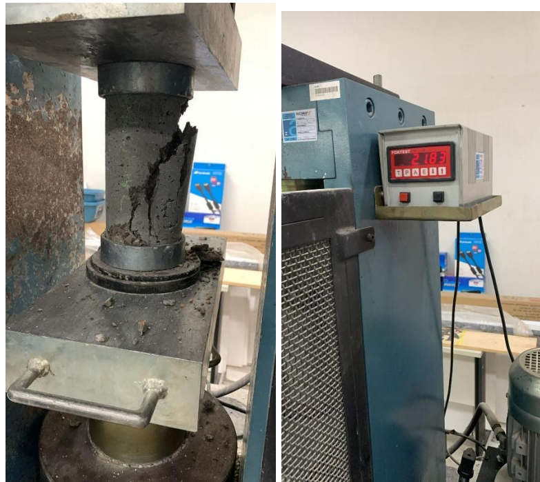
Imagens 7a) e 7b) – 7a) Ruptura do corpo de prova no ensaio de compressão e 7b) resultado do ensaio em Newtons
