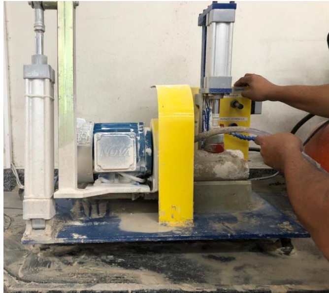
Imagem 1 – Extração do resíduo de corpo de prova na retífica
