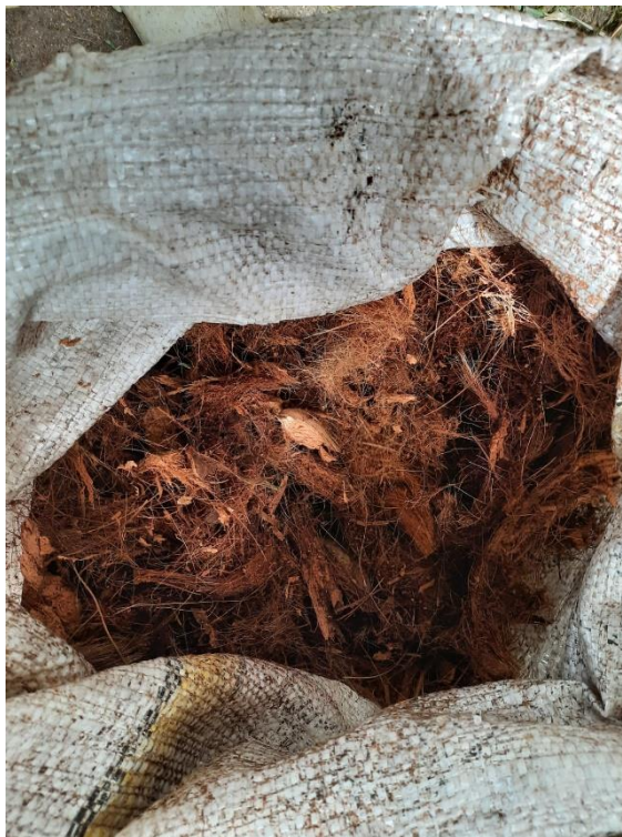
Figura 7: Resultado da trituração das cascas parcialmente secas
