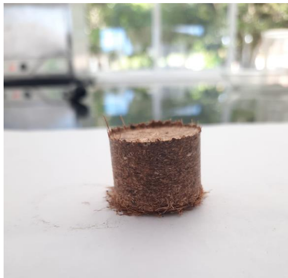
Figura 17: Amostra confeccionada com H 2 O sob temperatura de 70 °C
