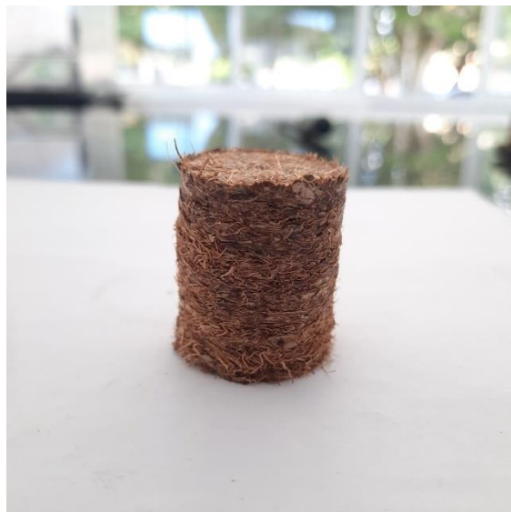
Figura 19: Amostra confeccionada com H 2 O sob temperatura ambiente.
