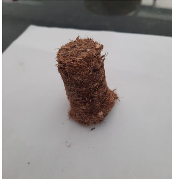
Figura 20: Amostra confeccionada com aglutinante de amido de milho sob temperatura de 70 °C.
