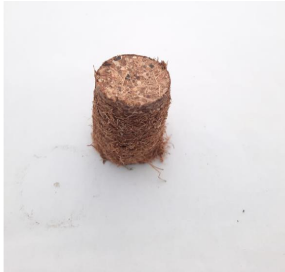
Figura 16: Amostra confeccionada com aglutinante de amido de milho sob temperatura de 70 °C
