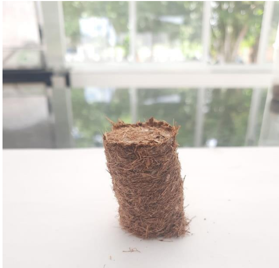
Figura 14: Amostra confeccionada com aglutinante de milho sob temperatura ambiente
