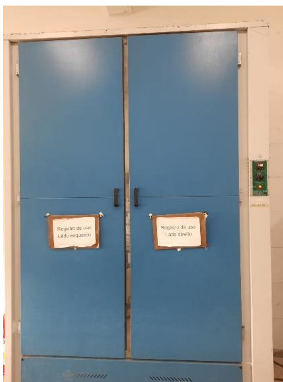
Figura 3: Estufa Marconi MA035 com circulação e renovação de ar.
