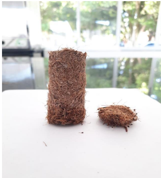
Figura 18: Amostra confeccionada com aglutinante de milho sob temperatura ambiente.
