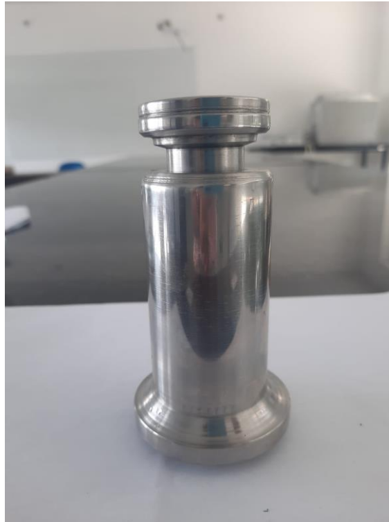
Figura 13: Molde para compactação do briquete
