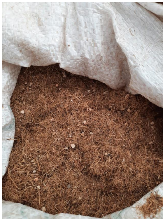
Figura 10: Fibra de coco processada 2x com auxílio da peneira de 3 mm e 0,8 mm
