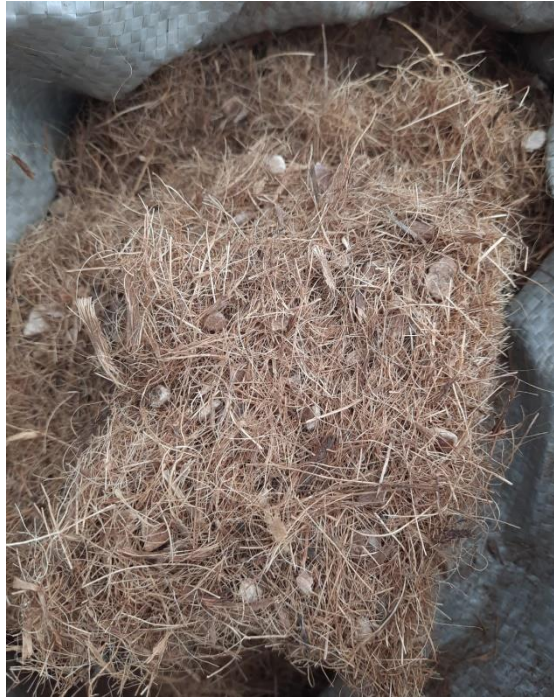
Figura 9: Fibra de coco processada apenas 1x com auxílio da peneira de 3mm
