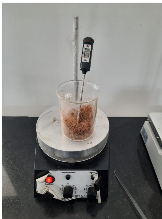
Figura 11: Aquecimento da amostra através de um agitador magnético com aquecimento e termômetro digital tipo espeto.
