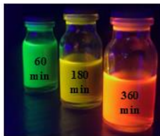
Figura 6: Efeito do confinamento quântico sobre as propriedades dos quantum dots sintetizados.
