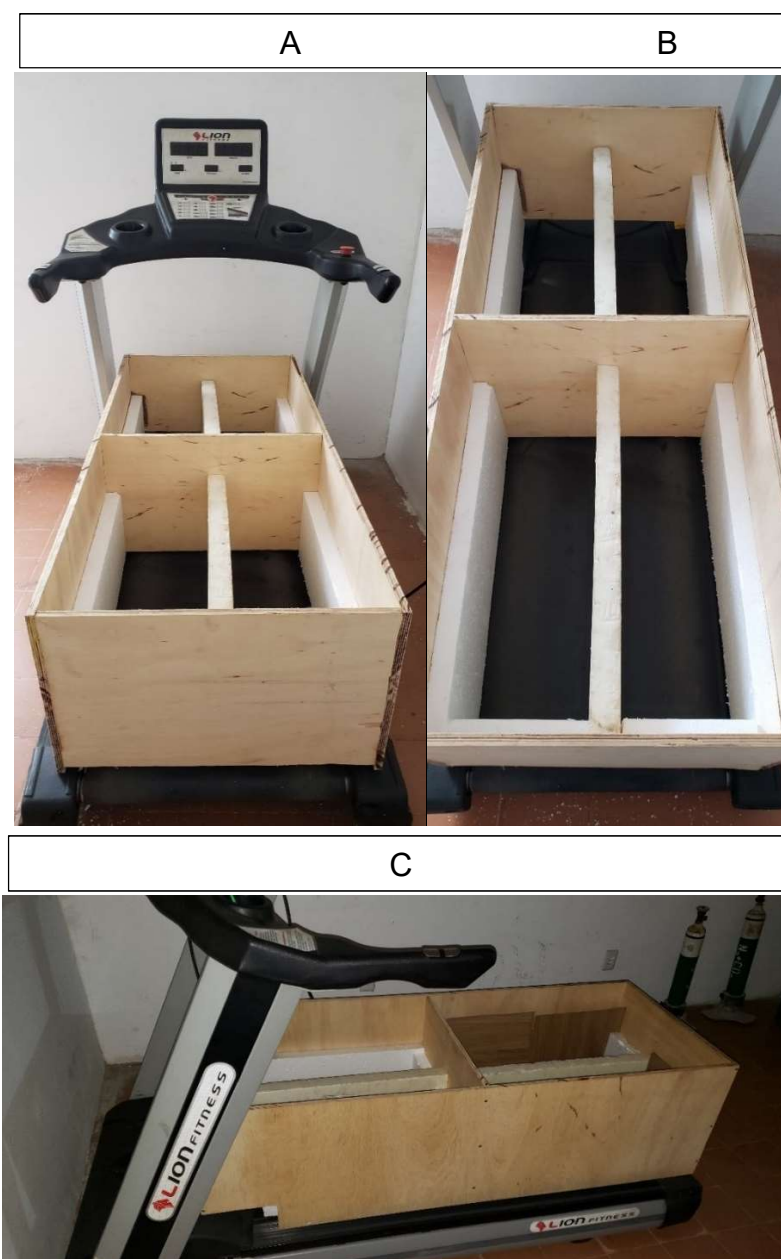
Figura 7 – Esteira motorizada adaptada com curral de MDF.
