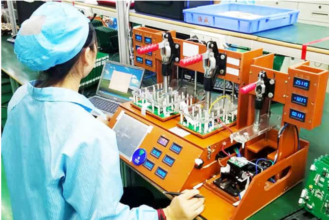
Figura 2.1: Exemplo de linha de teste de PCB, utilizando tecnologias ICT 1 .
