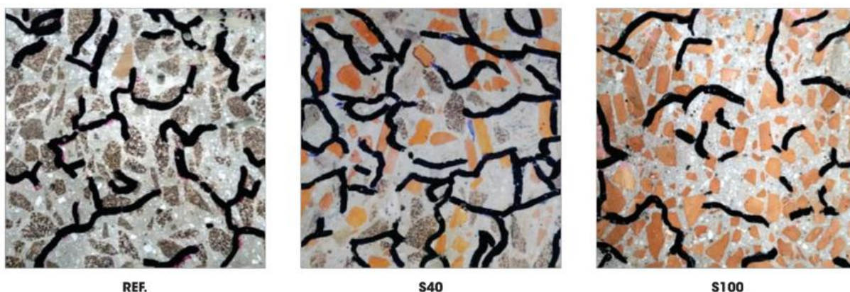
Figura 38: Corpos de prova, apresentando fissuras após ensaio de lascamento explosivo (temperatura: 925 °C).
