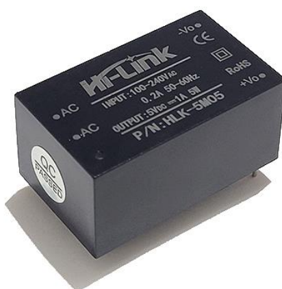
Figura 11 - Fonte DC Hi-Link HLK-5M05.
