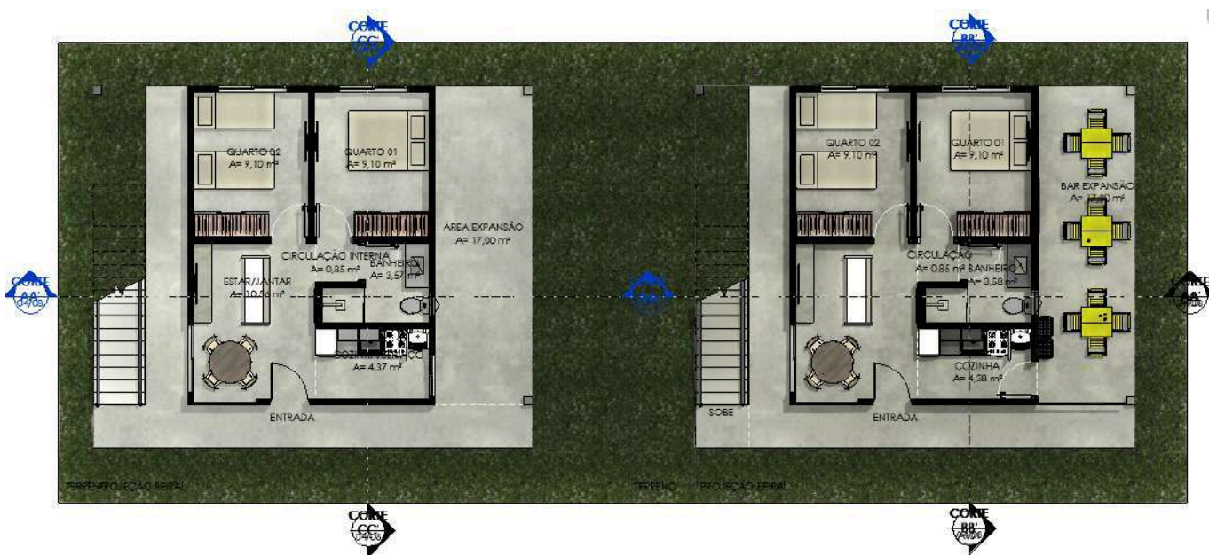
Figura 54 : Planta baixa humanizada pavimento térreo, propostas com e sem intervenção.
