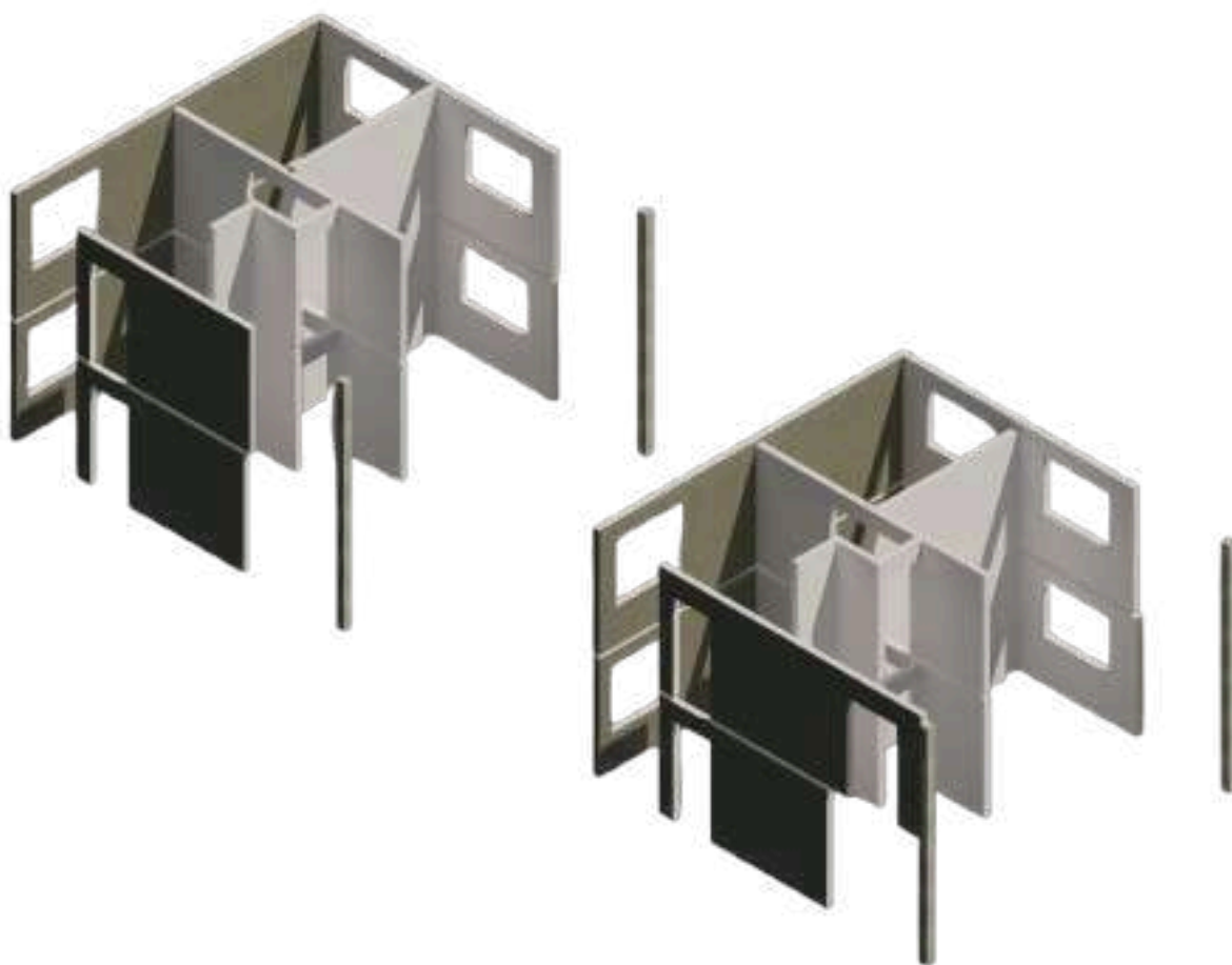
Figura 53: Isometria estrutural da habitação de interesse social incremental
