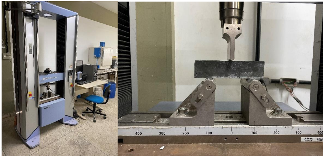
Figura 20 - Prensa Shimadzu e ensaio de tração na flexão
