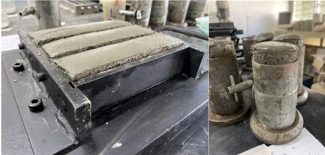
Figura 13 - Expansão volumétrica dos corpos de prova
