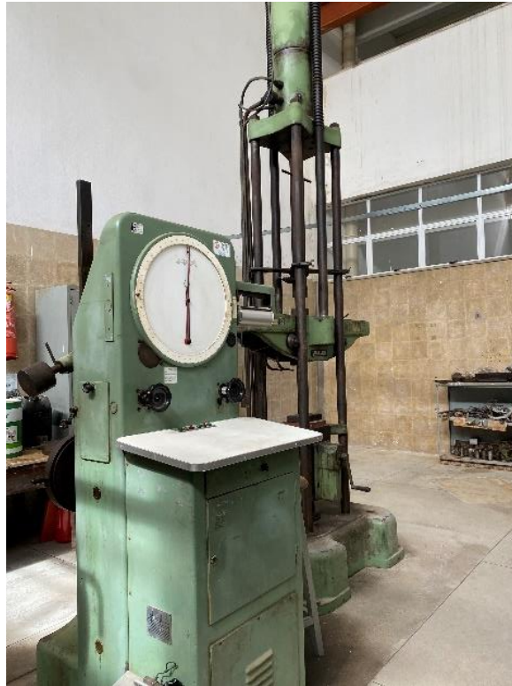
Figura 19 - Prensa de Amsler e ensaio de compressão corpo de prova prismático
