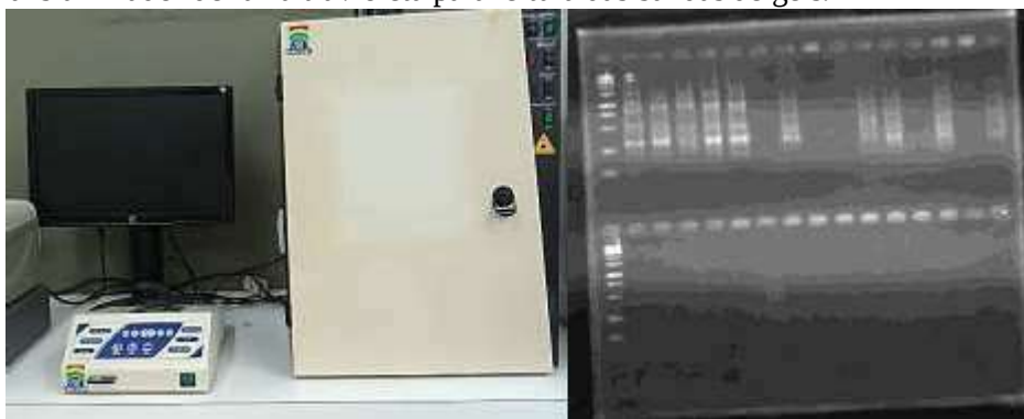
Figura 5. Transiluminador de luz ultravioleta para leitura das bandas de géis.
