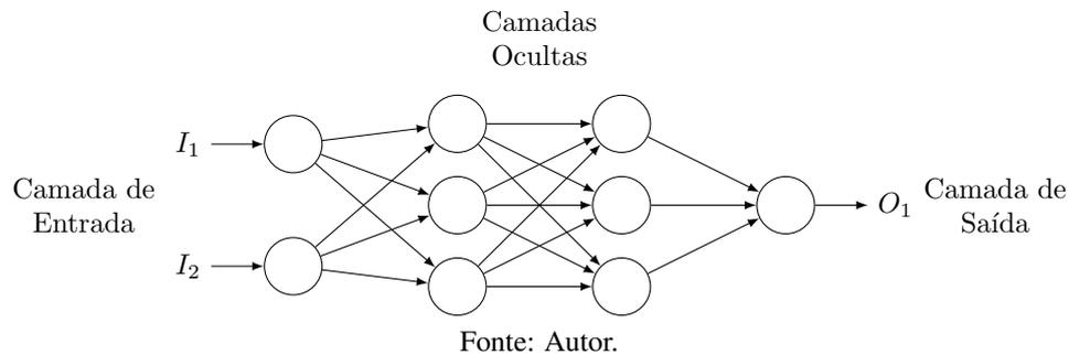
A configuração de uma MLP típica é ilustrada na Figura 2.3, com duas variáveis de entrada, duas camadas ocultas e uma variável de saída. Nesta arquitetura, o fluxo de propagação é representado pela fase *forward*, enquanto a fase de correção, ou *backward*, ocorre quando os pesos sinápticos são ajustados após o cálculo dos erros.
