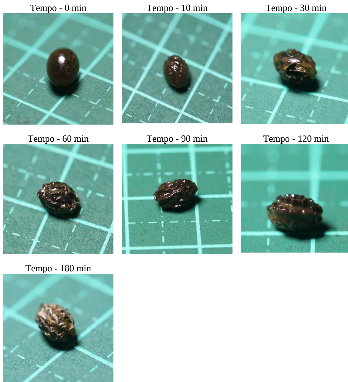
Figura 14 - Partícula isolada em cada instante de tempo na secagem
