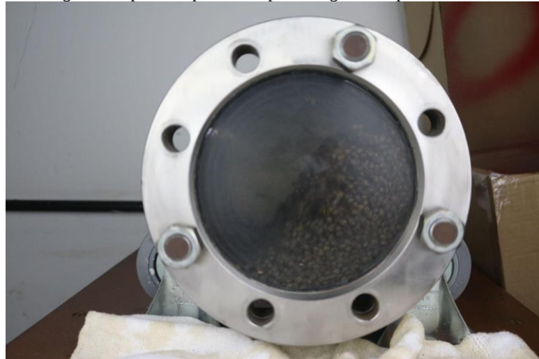
Figura 8 - Aparato experimental para o ângulo de repouso dinâmico
