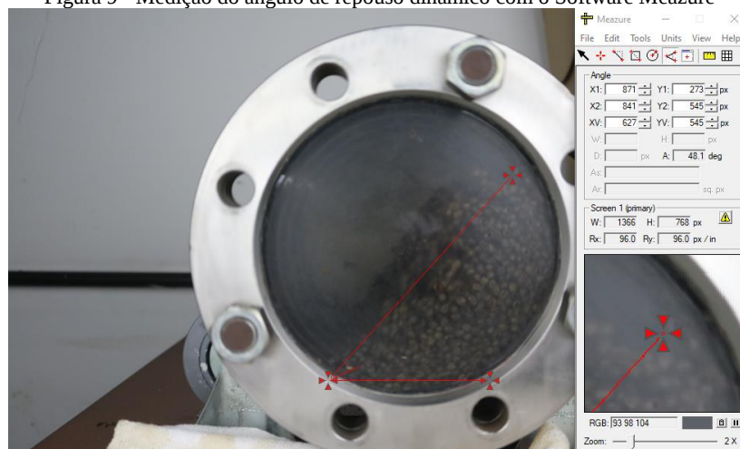
Figura 9 - Medição do ângulo de repouso dinâmico com o Software Meazure
