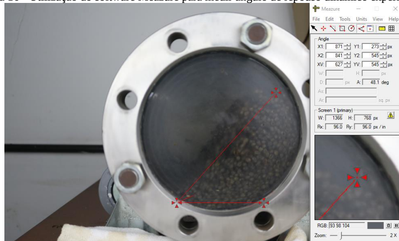
Figura 16 - Utilização do software Measure para medir ângulo de repouso dinâmico experimental.
