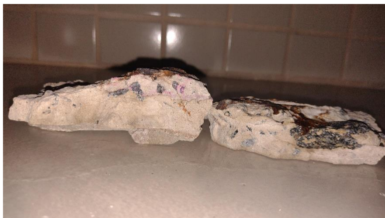
Figura 32 – Ensaio de carbonatação do pilar 28 do bloco 5
