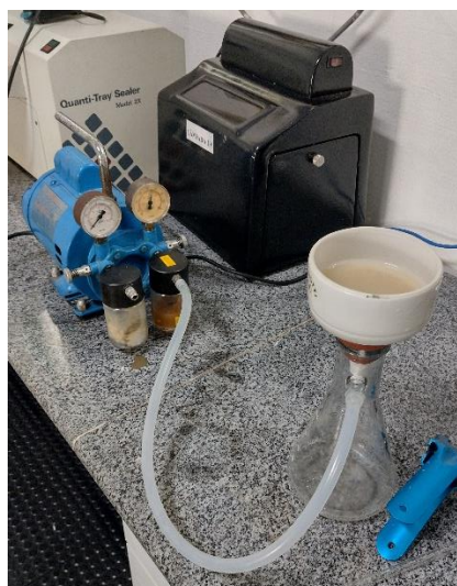
Figura 22 – Filtração do concreto pulverizado
