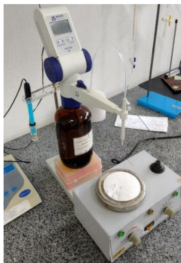
Figura 25 – Titulação com ácido sulfúrico para identificação de nitrato de amônio
