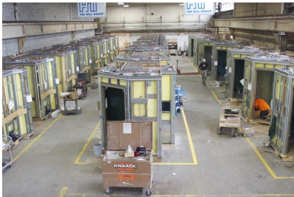
Figura 13: Exemplo de Nível 3 – Módulos de banheiros
