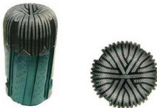
Figura 7 - Broca de diamantes industrializados
