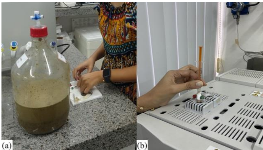
Figura 12 – Preparação para a coleta do gás (a) e posicionamento para injeção manual no equipamento de cromatografia gasosa (b).
