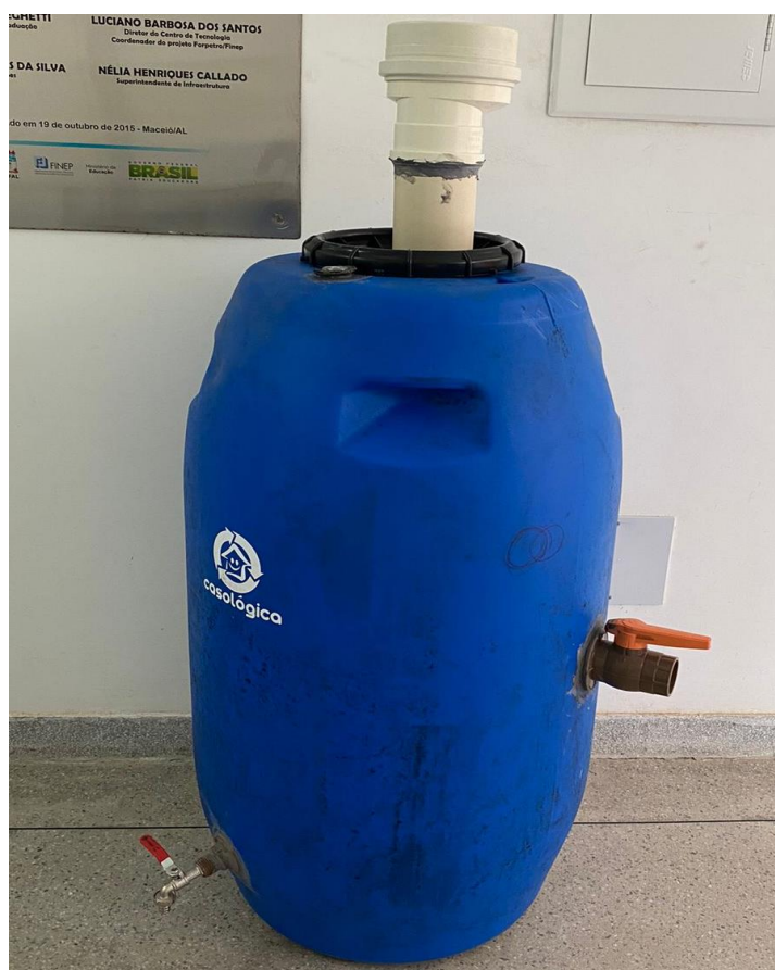
Figura 13 – Resultado da estruturação do biodigestor proposto.
