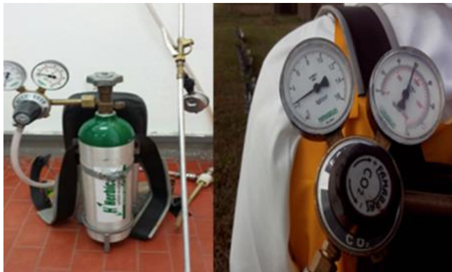
Figura 5 - Pulverizador costal pressurizado a \text{CO}_2 , utilizado na aplicação dos tratamentos nos experimentos, e o manômetro indicando a pressão do equipamento durante as aplicações.
