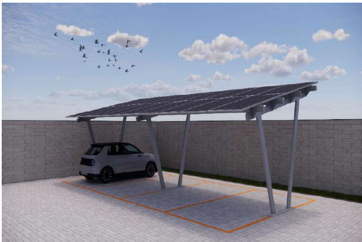
Figura 30 – Imagem ilustrativa do carport com 2 linhas de placas solares para o estacionamento da UFAL Campus Sertão.
