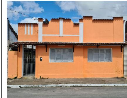
Presença de platibanda com desenho particular e pingadeiras em telha cerâmica. Implantação com espaço lateral e menos ornamentos de fachada.
