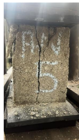
Figura 6.22 - Características de rupturas de cada conjunto de bloco (a) AN; b) AMR+AGN; (c) AMN+AGR.
