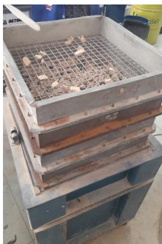
Figura A.16 – Etapa de separação das frações granulométricas para ensaio de abrasão
