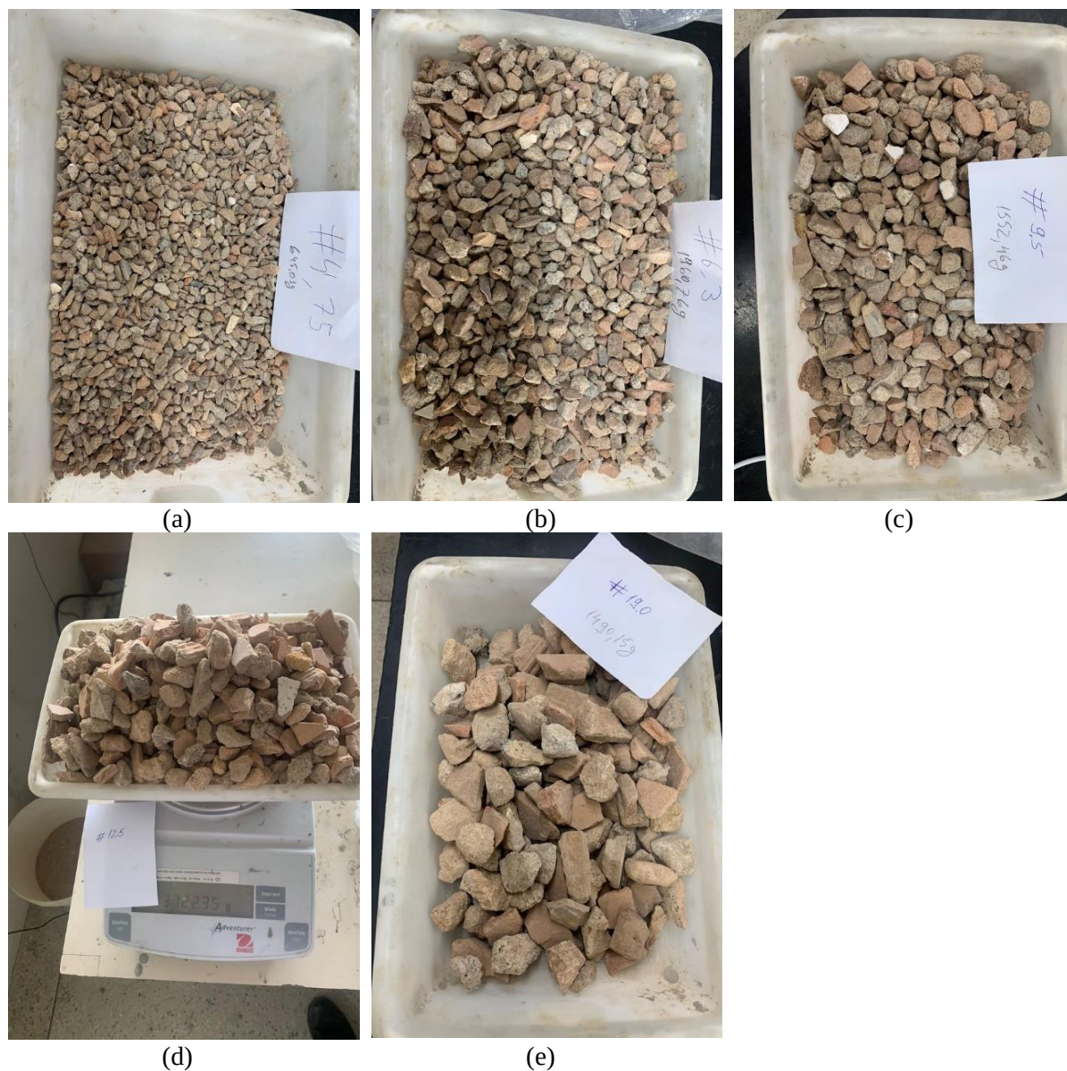
Figura A.13 – Ensaio de índice de forma do AGRP: (a) diâmetro de 4,75 mm; (b) diâmetro de 6,3 mm; (c) diâmetro de 9,5 mm; (d) diâmetro de 12,5 mm; (e) diâmetro de 19 mm
