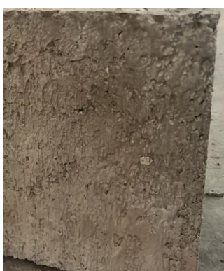
Figura 6.15 - Aparência dos blocos de concreto com tonalidades diferentes utilizando agregado: (a) naturais (NAT); (b) miúdo reciclado e graúdo natural (AMR); (c) miúdo natural e graúdo reciclado (AGR)
