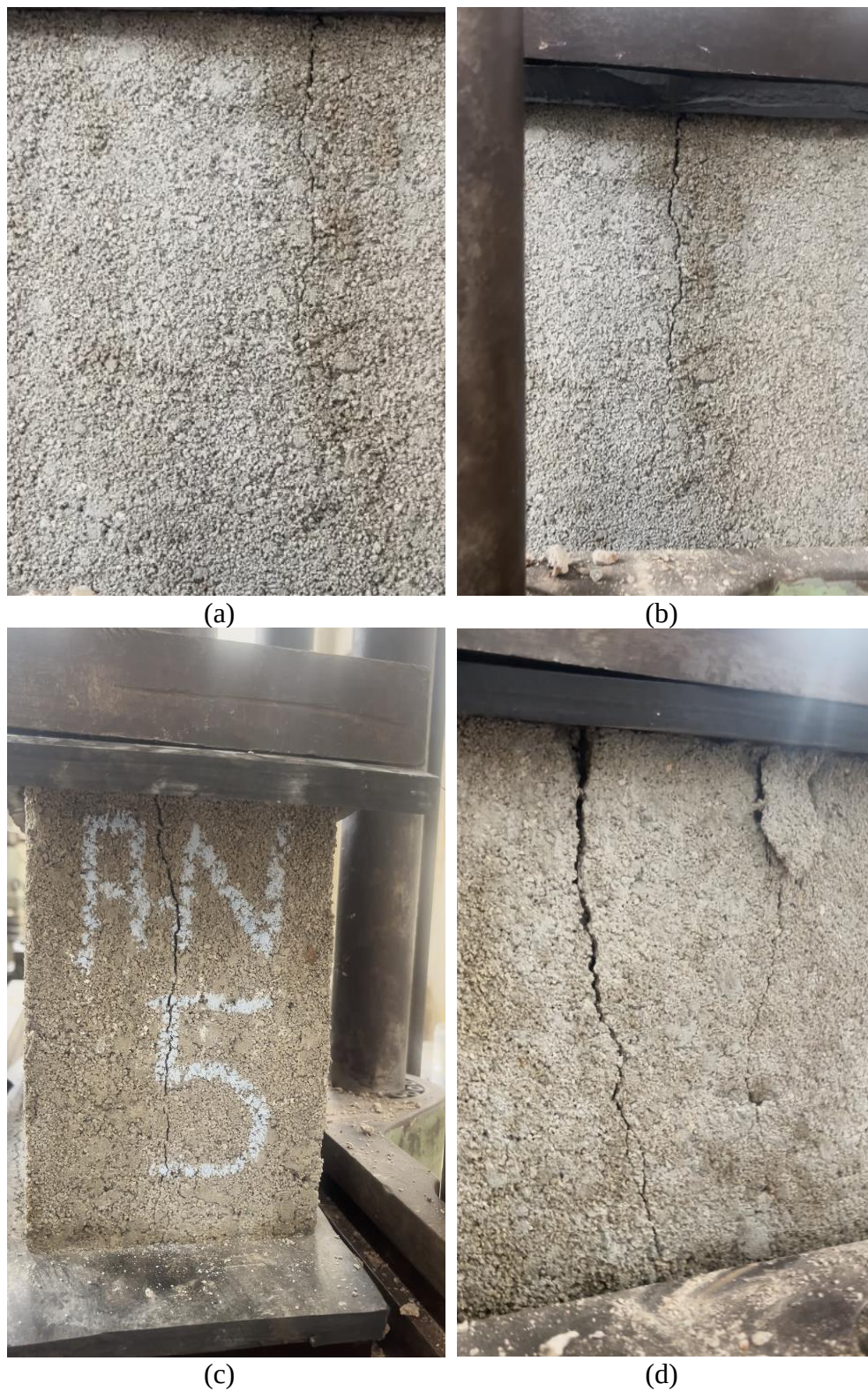
Figura 6.19 - Surgimento de fissuras (AN): (a) 6 toneladas; (b) 9 toneladas; (c) 12 toneladas; (d) 15 toneladas
