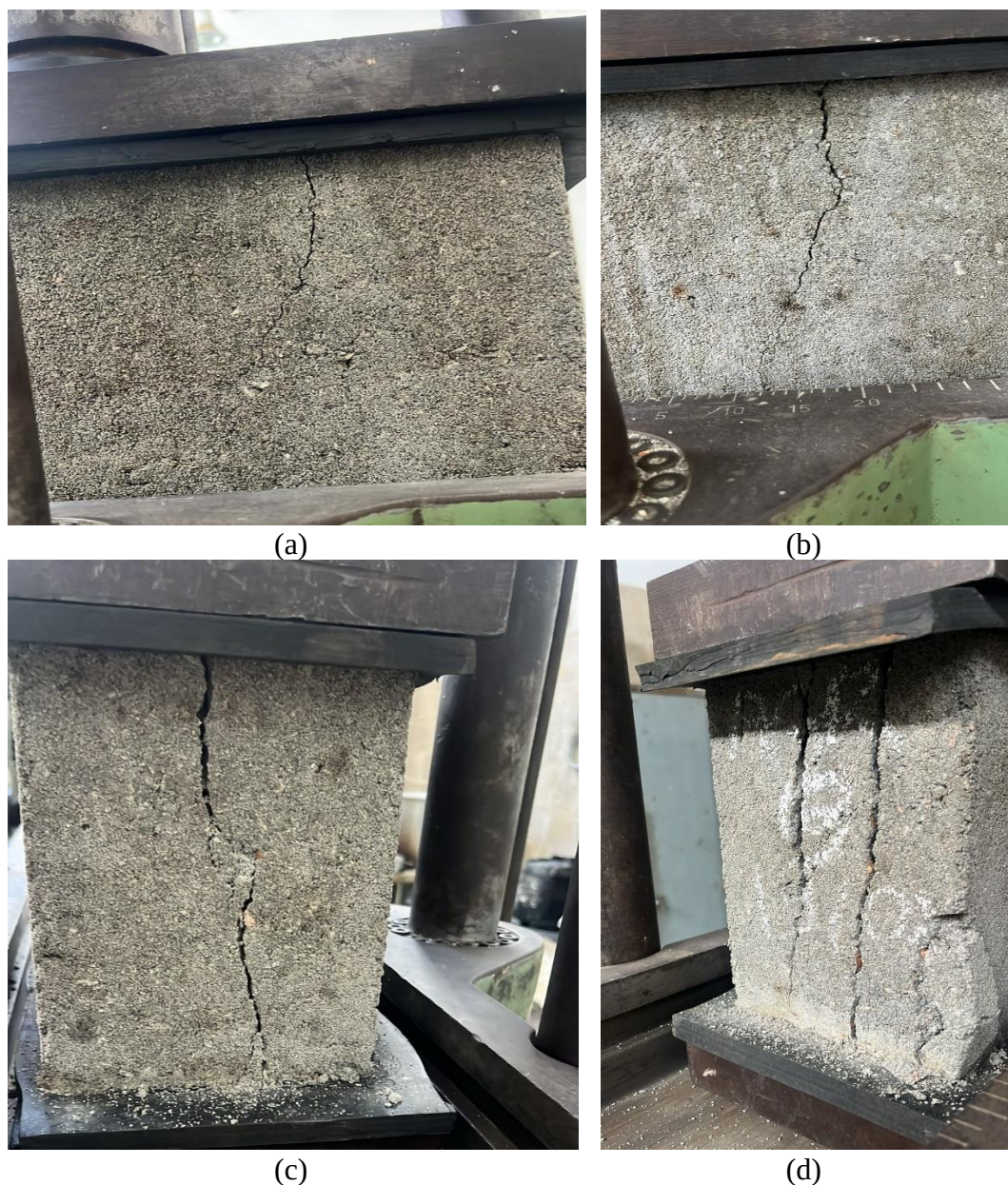
Figura 6.21 - Surgimento de fissuras (AMN+AGR): (a) 3 toneladas; (b) 9 toneladas; (c) 13 toneladas; (d) 16 toneladas.
