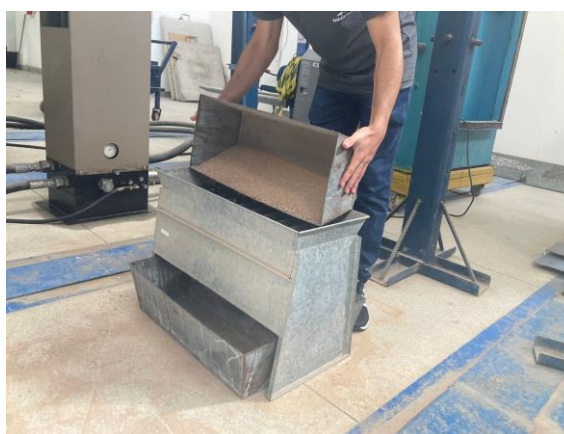
Figura A.2 - Quarteamento dos agregados reciclados primários
