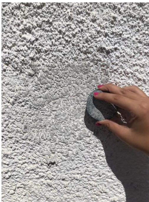
Figura 23: Área do ensaio preparada através do uso do carborundum.
