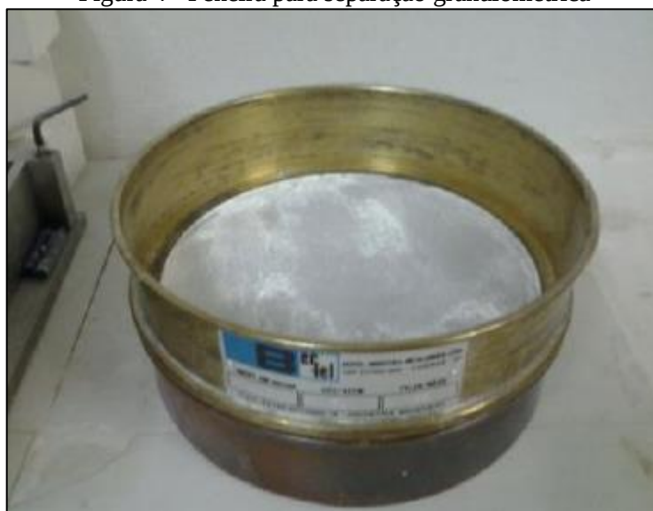
Figura 4 - Peneira para separação granulométrica
