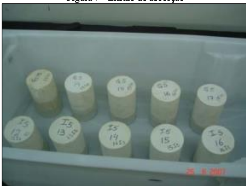
Figura 7 - Ensaio de absorção
