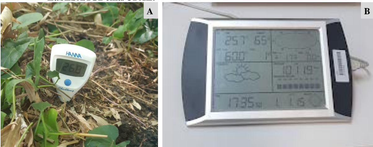
Figura 12 - Medição da temperatura do solo (A) e painel da estação meteorológica (B) do LabESA/IGDema/UFAL.
