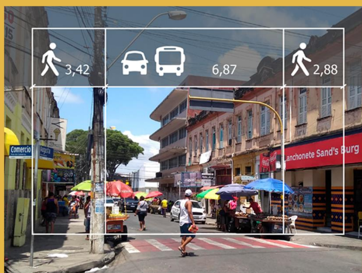
Imagem 46: Dimensões da via na Rua das Árvores.
