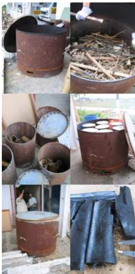
Figura 6 – Etapas de fabricação do carvão de bambu
