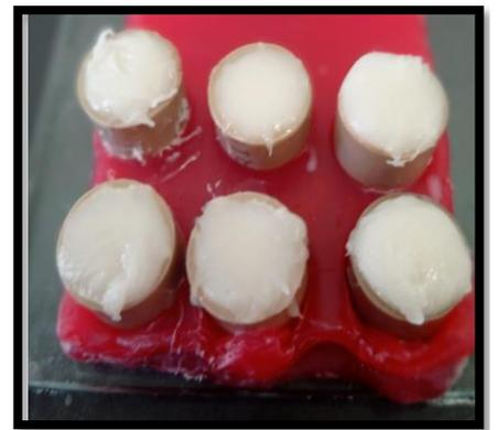
*Embutimento em resina acrílica autopolimerizável*
