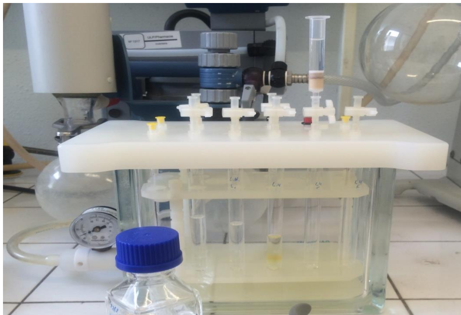
Figura 10 - Representação do dispositivo com sistema extrator a vácuo utilizado na SPE
