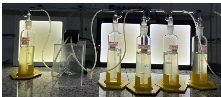
Figura 9 – Modelo adotado para simulação de reator tubular aerado
