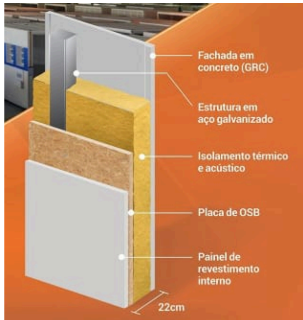
Figura 05: Estrutura no interior das paredes dos módulos para construção do sistema
