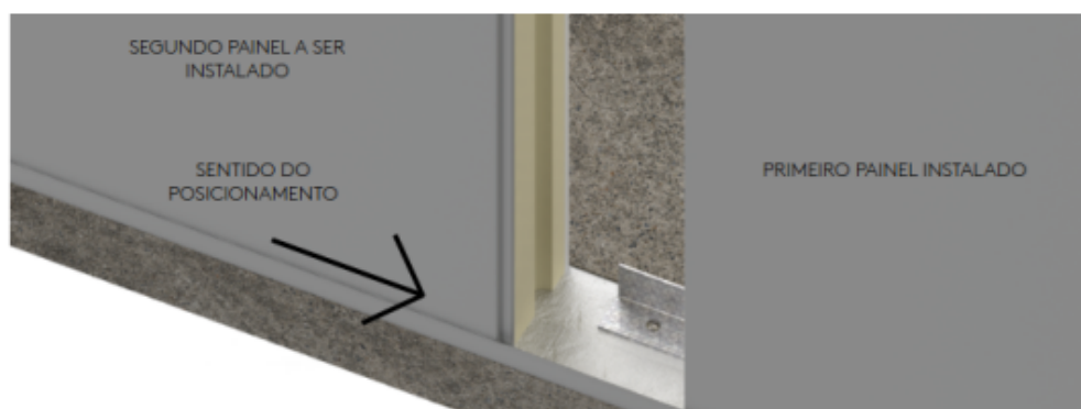
Figura 19: Modo de encaixe dos painéis SmartWall da Creche CRIA do município de Pindoba/AL
