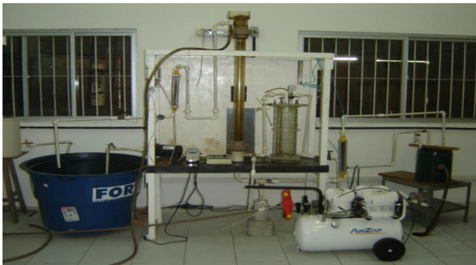
Figura 2. Unidade de separação por flotação com ar dissolvido
