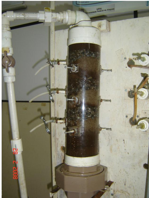
**Figura 6. Filtro adsorvente operando com o uso de pedras**
