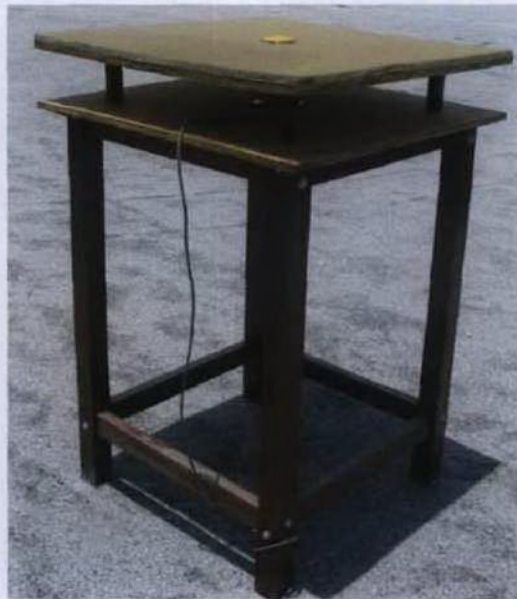
Figura 6.2 – Detalhe do suporte do Disdrômetro RD-69 para fixação da parte externa.
